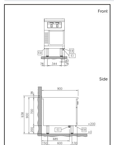
Electrical inlet (power) EQ **Equipotential** screw
